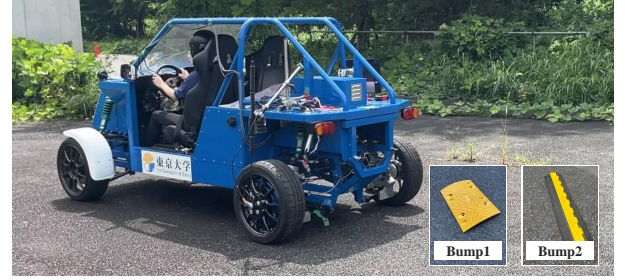
Fig. 8: Fig.8: 実験車両 FPEV5. バンプ 1(丸型バンプ): 奥行き 35cm, 高さ 4.5cm, バンプ 2(台形型バンプ): 底辺 30cm, 上辺 18cm, 高さ 5cm
