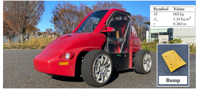
Fig. 3: 実験車両 FPEV2-Kanon 丸型バンプ: 奥行き 35cm, 高さ 4.5cm Fig.3: The experimental vehicle is FPEV2-Kanon. Bump is round, with a width of 50 cm, a depth of 35 cm
