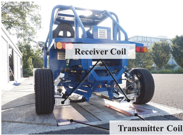
図-1 走行中給電システム
